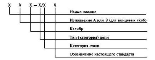
Пример условного обозначения общего звена калибра 50 мм, литого, повышенной прочности:
