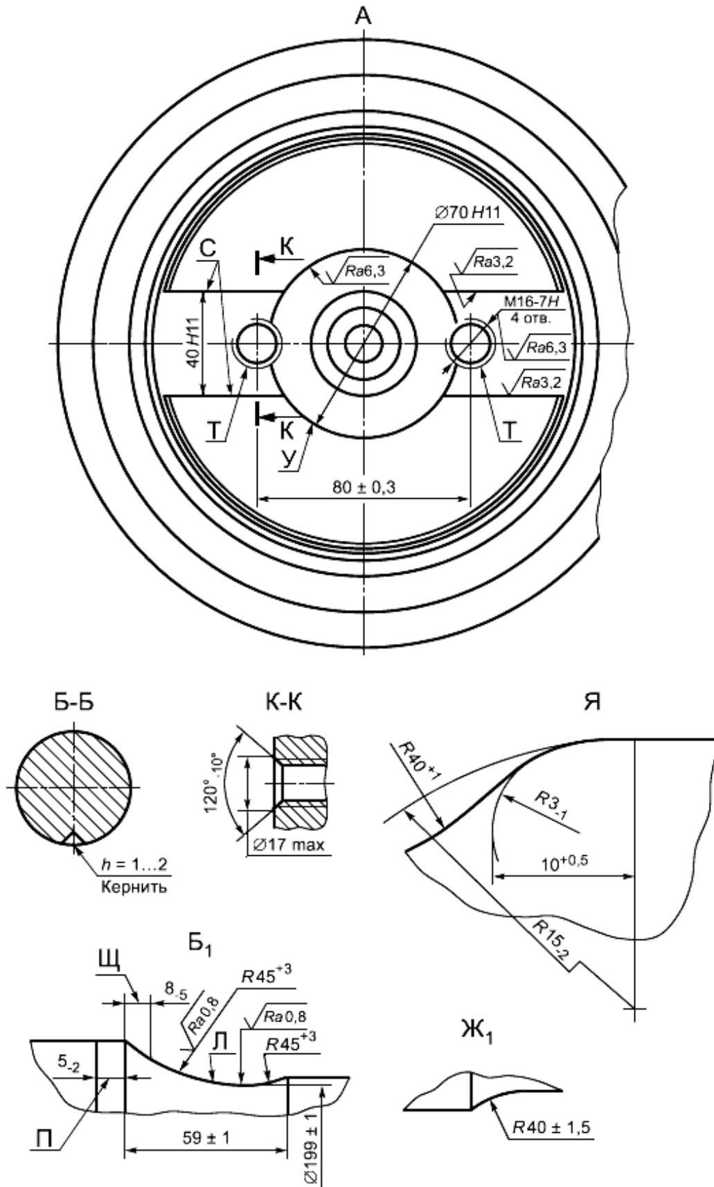
Допуск радиального биения при контроле в центрах поверхностей В, Г, Д, Е - не более 0,05 мм, остальных поверхностей - не более 0,3 мм.
