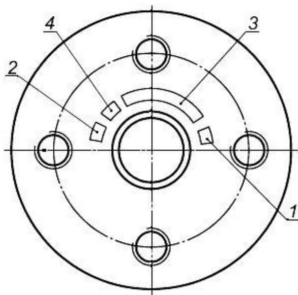
1 - приемочные клейма; 2 - условный номер предприятия - изготовителя чистовой оси по [1]; 3 - номер оси, включающий условный номер предприятия - изготовителя черновой оси по [1] - 4 знака (если условный номер менее 4 знаков, его дополняют нулями с левой стороны), порядковый номер черновой оси - до 6 знаков, две последние цифры года изготовления черновой оси - 2 знака; 4 - клеймо службы технического контроля предприятия - изготовителя чистовой оси
