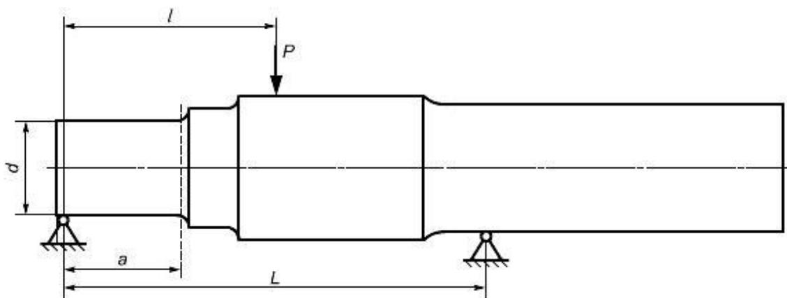
$d$  - диаметр шейки оси;  $P$  - циклическая нагрузка;  $L$  - расстояние между опорами;  $l$  - расстояние между центром сечения опоры и точкой приложения нагрузки;  $a$  - расстояние от центра опоры шейки до сечения разрушения оси в зоне галтели
