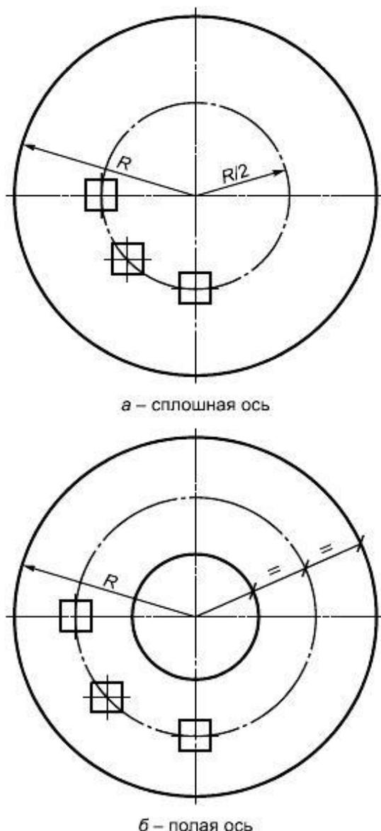
Рисунок 5 - Положение трех заготовок для изготовления шести образцов для контроля загрязненности стали осей
