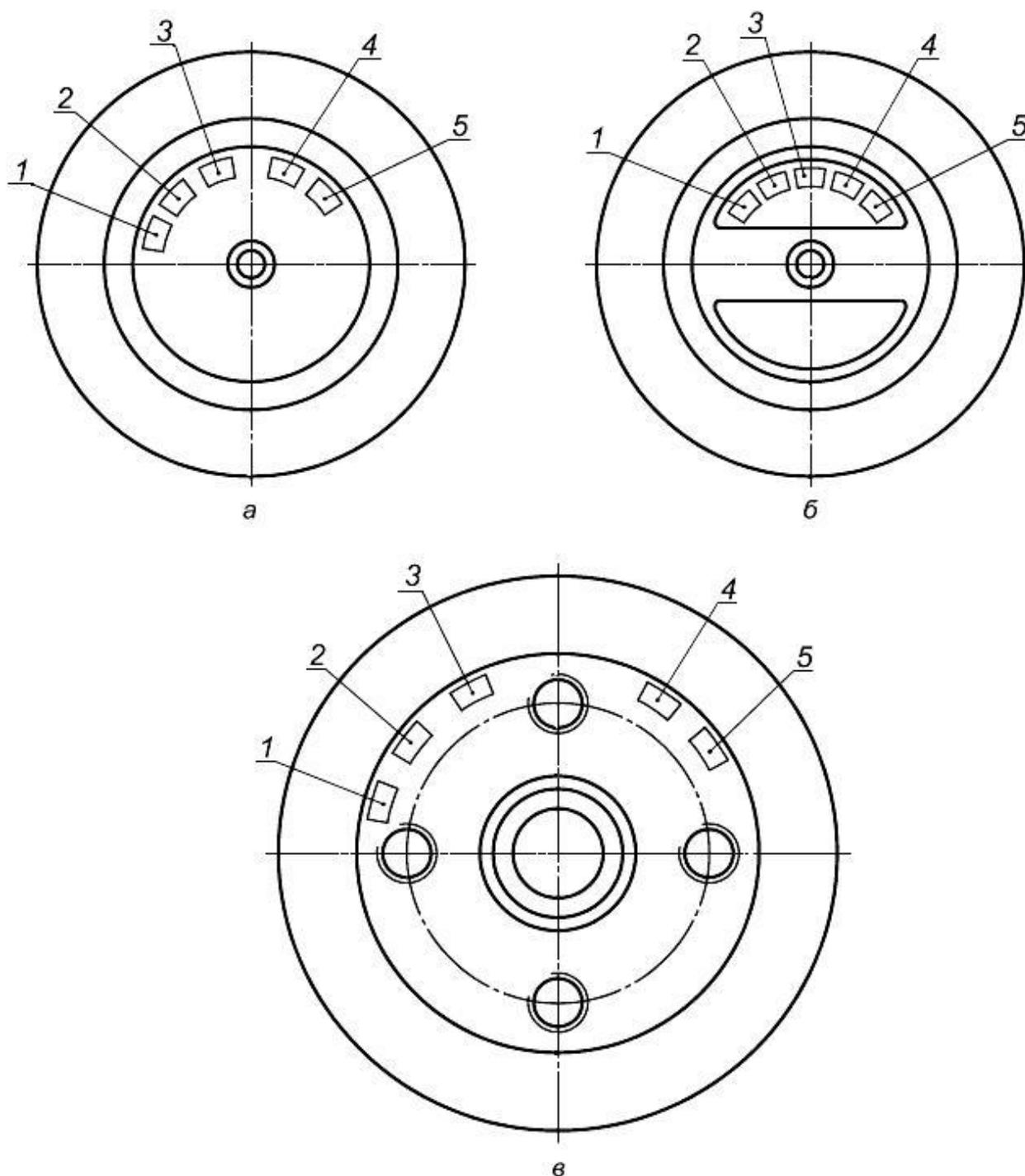
а - для осей колесных пар с подшипниками скольжения или качения без торцевого крепления гайкой; б - для осей колесных пар с подшипниками качения с торцевым креплением гайкой; в - для осей колесных пар с подшипниками качения с торцевым креплением шайбой
