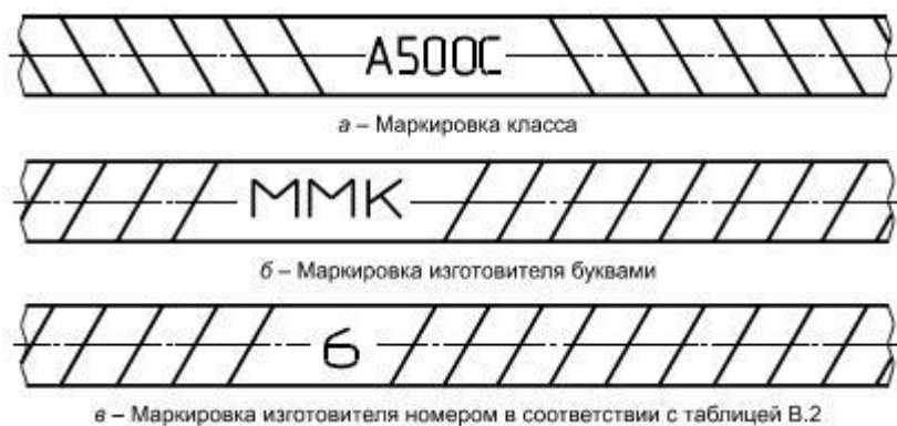
Рисунок В.1 - Маркировка проката надписью
