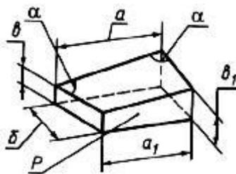
Рисунок 4 - Размеры трапецеидального клина с соотношением  $\frac{b}{b_1} \leq 1$
