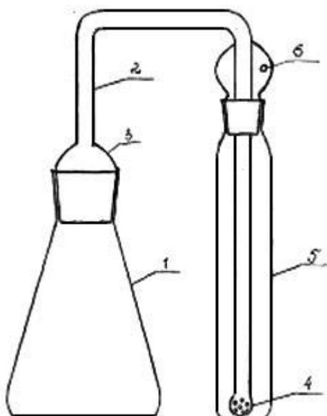
1 - Реакционный сосуд; 2 - отводная трубка; 3 - расширение для ваты; 4 - барботер; 5 - пробирка; 6 - отверстие
