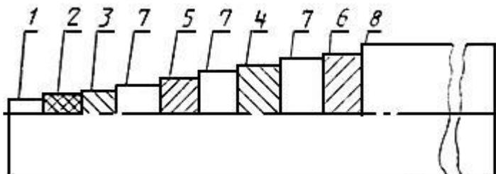
1 - внутренний резиновый слой; 2 - текстильный защитный слой; 3 и 4 - силовые слои с правым направлением навивки; 5 и 6 - силовые слои с левым направлением навивки; 7 - промежуточный резиновый слой; 8 - наружный резиновый слой
