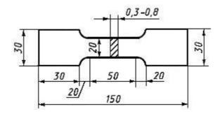
Скорость передвижения активного захвата машин при растяжении образцов должна быть 10-15 мм/мин.
